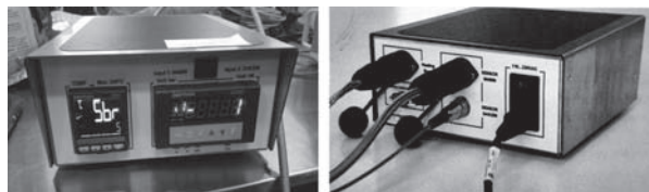
图 2 熔体压力温度在线测量系统监视器(左为正面、右为背面)
